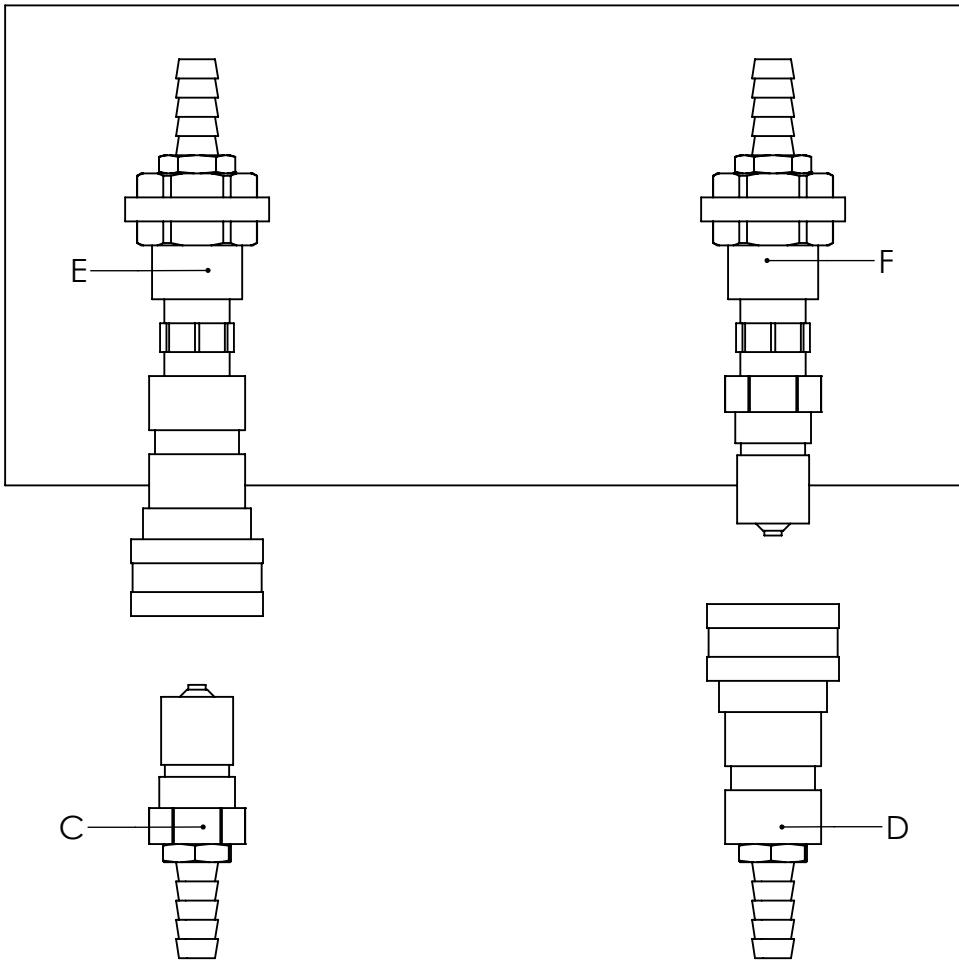
C: Raccord rapide mâle 3/8/ Raccord à boyau mâle 3/8 1x
